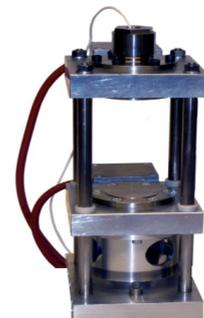
*Bild 1: Ultraschallmessvorrichtung hier pneumatische Minipresse mit temperaturgeregelter Ober- und Unterplatte und integrierten Ultraschallsensoren, Probendurchmesser 50 mm*
